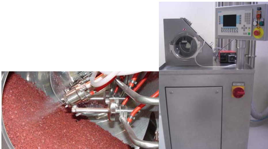
Figura 23 – Tambor perfurado em escala piloto. Fonte: (www.almapal.com.br)
