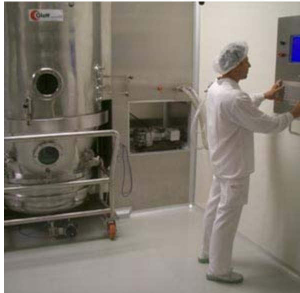
Figura 24 – Foto leito fluidizado. Fonte: ( www.almapal.com.br .)
